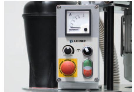
Stufenlose Feineinstellung der Dosiermenge mithilfe der Drehzahl der Zellenradwelle. Die Lastaufnahme des Entspelzerantriebs wird hierbei elektronisch überwacht und die Drehzahl bei Bedarf angepasst, um eine Überlast bzw. Überdosierung zu vermeiden.
