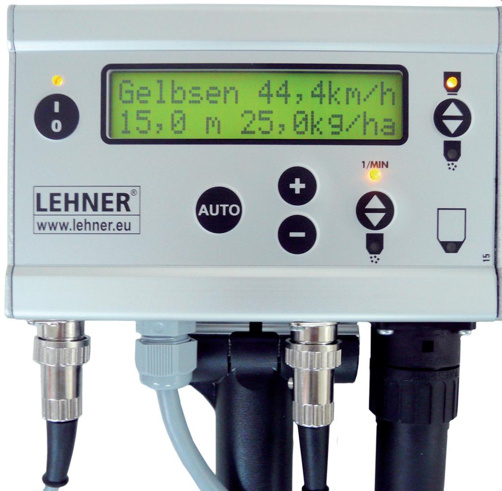
Avec **AUTO-DOSIS**, la position du clapet s'adapte automatiquement à la vitesse de déplacement. Il suffit d'indiquer une quantité à épandre par hectare et le système électronique règle le reste. En fonction de la vitesse de déplacement du véhicule tracteur, la commande règle automatiquement le clapet de distribution de manière que le débit réglé soit toujours constant.
