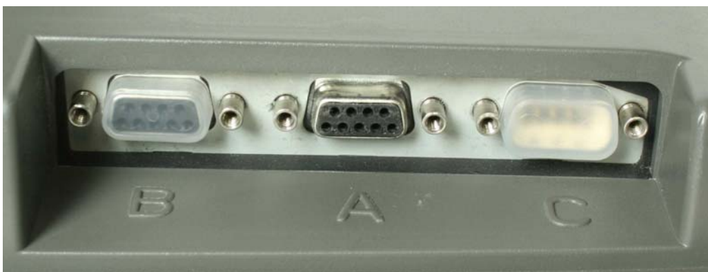
Abb. 3-6: Anschlüsse an der Unterseite des COMFORT - Terminal
