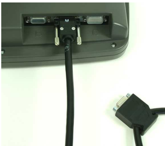
Abb. 3-8: COMFORT-Terminal mit Anschlußkabel des MFG und Anschluß für die Grundausrüstung
