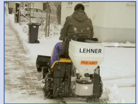
POLARO® 70 am Aufsitzmäher mit Schneeräumschild
